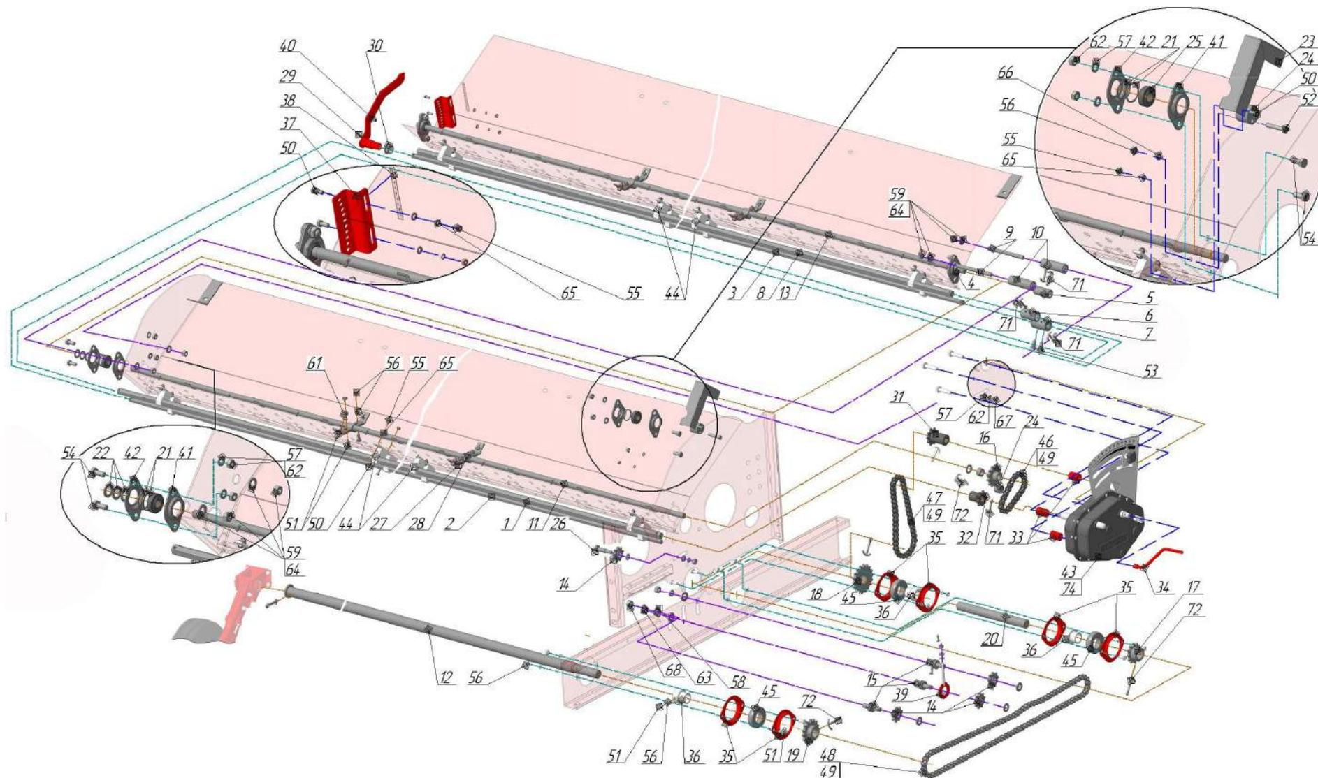
Рисунок 4 – СЗУ 6.04.00.00.00 Привод высевяющих аппаратов
