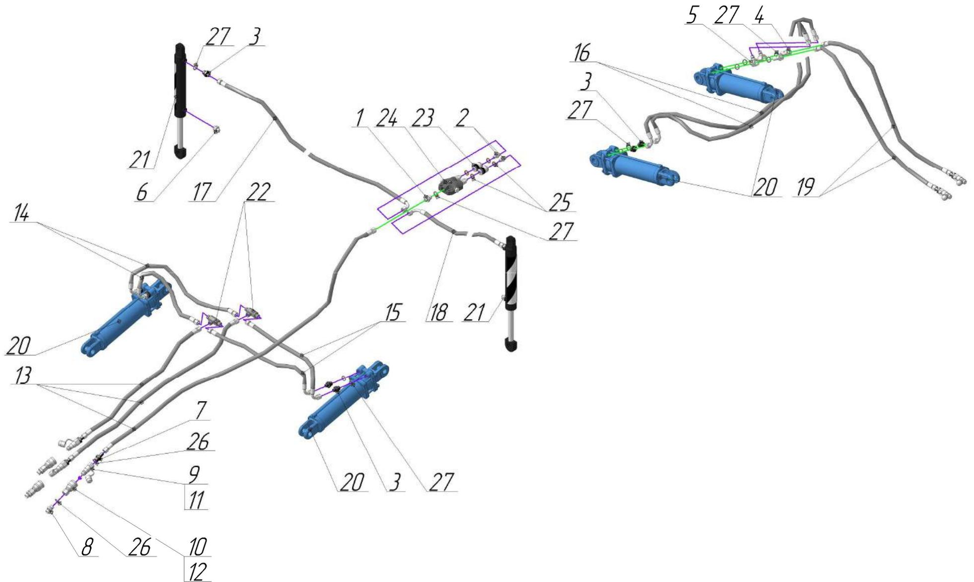
Рисунок 10 – СЗУ-6.20.00.00.00 Гидросистема
